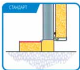
Камера холодильная с соединением «шип-паз», с дверью без порога
