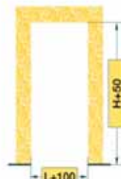
Облицовка проема ПВХ-профилем
