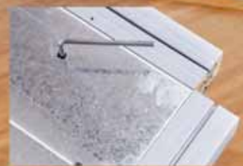
Монтажная пленка удаляется после окончательной сборки камеры
