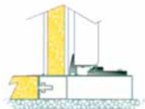
С панелью порога при положительной температуре
